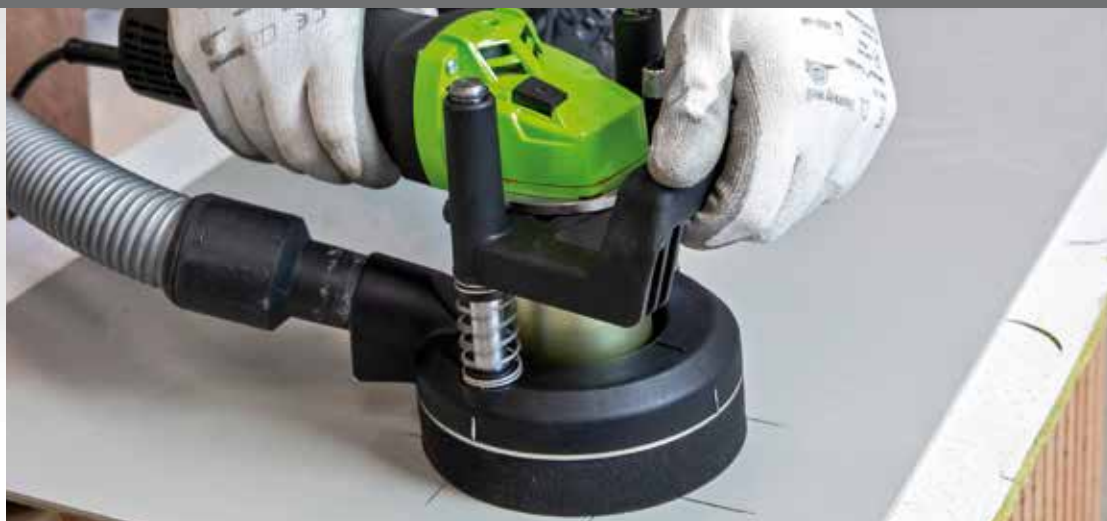
Drehzahlregulierung Geschwindigkeitsanpassung an die jeweilige Bohrkronengröße
