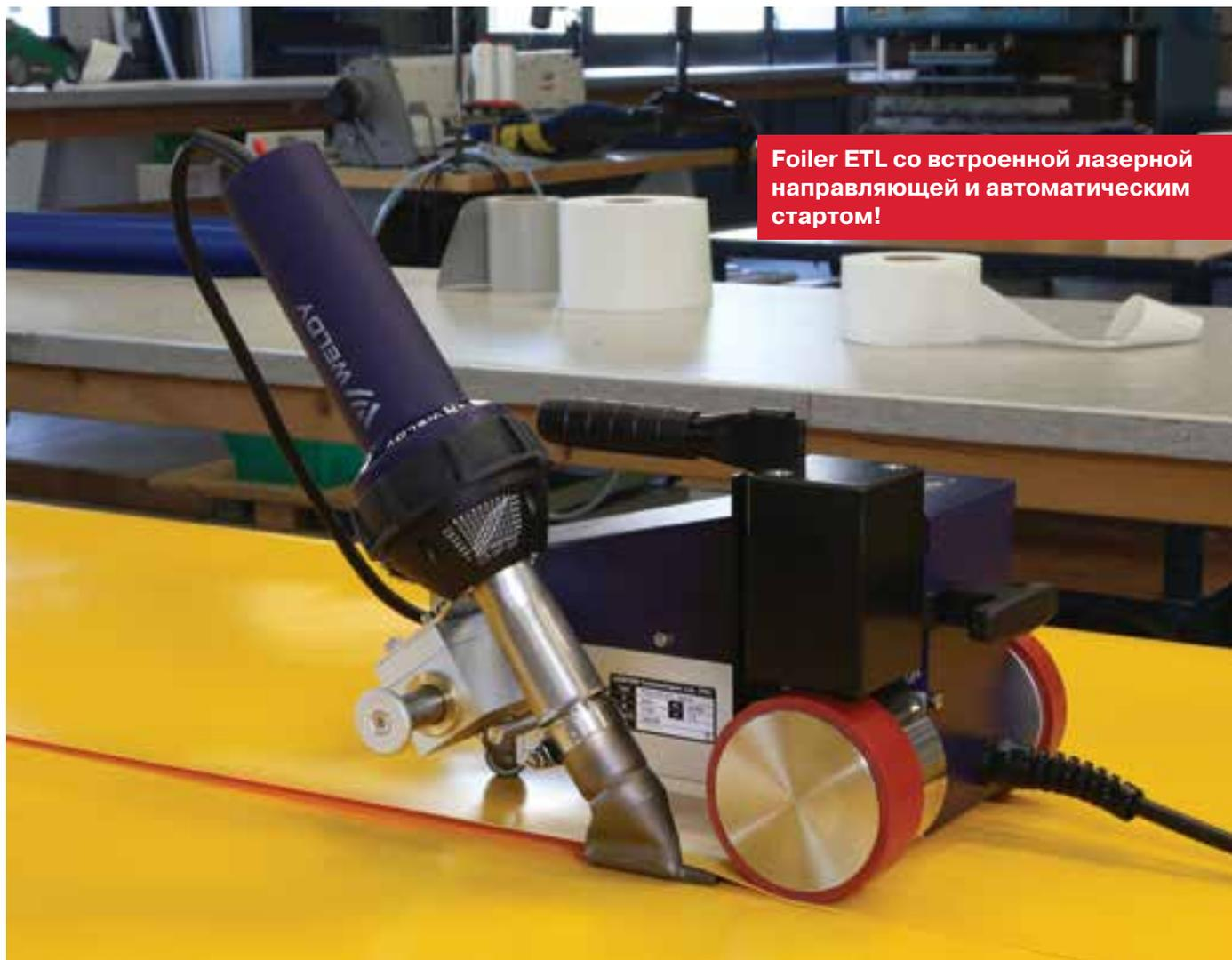
Foiler ETL со встроенной лазерной направляющей и автоматическим стартом!
