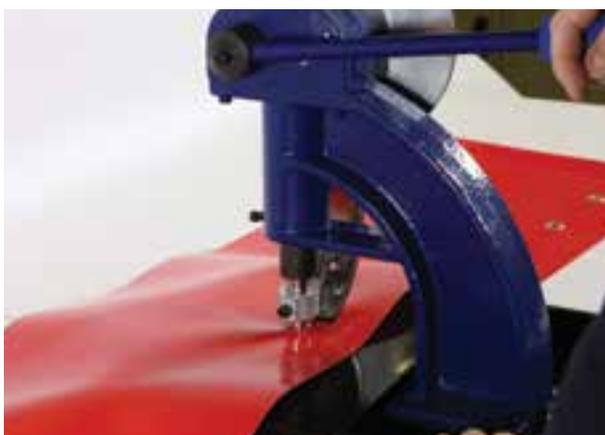
Пробивка отверстия и установка люверса — 1 шаг!
